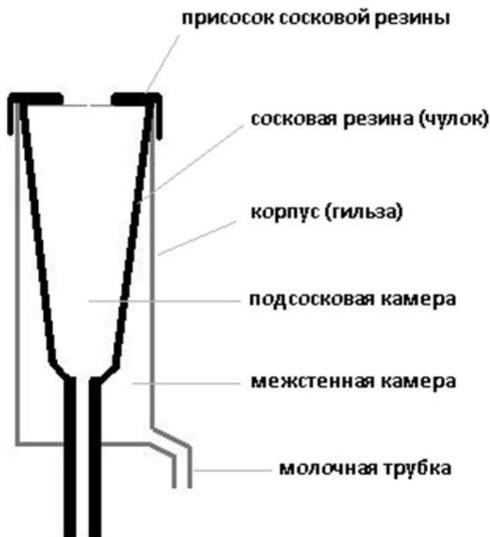
Во время доения, в межстенной камере создается переменный вакуум – он периодически сменяется атмосферным давлением. В момент, когда в межстенной камере создается вакуум, сосковая резина распрямляется, сосок разжимается и на него действует вакуум в подсосковой камере. Молоко выходит. Смена вакуума в межстенной камере атмосферным давлением сжимает резину, сосок закрывается. Затем цикл повторяется.
