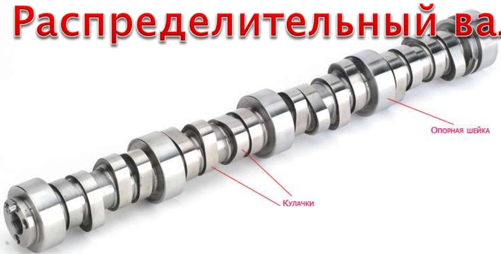
Распределительный вал служит для открытия клапанов в определенной последовательности в соответствии с порядком работы двигателя. Распредвалы отливают из специального чугуна или отковывают из стали.
